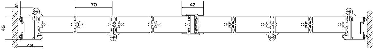
INGOMBRO SPESSORE TELAIO IN SPALLA MM 45 A CUI AGGIUNGERE MM 25 PER L'INGOMBRO DI ROTAZIONE DEL GANCIO SPAGNOLETTA.
